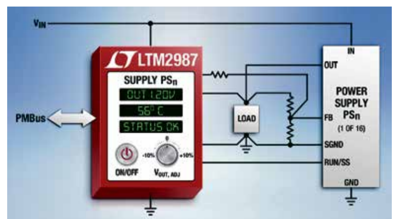
Fig 3. LTM2987: 16-kanalig μModule PMBus DPSM med 0,25-procents noggrann trimning, marginalsättning och övervakning.
